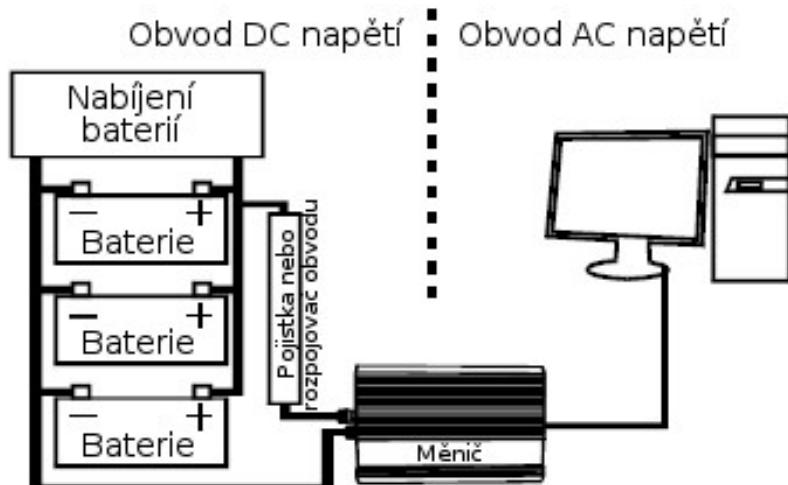
Z bezpečnostních důvodů je doporučeno zapojit na kladný napájecí vodič pojistku nebo ochranný rozpojovač obvodu. Pojistku vyberte dle očekávaného přenášeného výkonu (tedy např. při 1000 W doporučujeme 150 A DC, při 1500 W doporučujeme 200 A DC).
