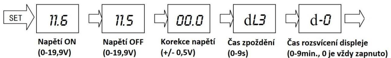
Po připojení napětí se zobrazí napětí napájecího zdroje. Pokud je napětí vyšší než nastavené napětí ON, výstup se zapne. Pokud je napětí nižší než nastavené napětí OFF, výstup se vypne (nastavená hodnota napětí OFF nemůže být vyšší než hodnota napětí ON).
