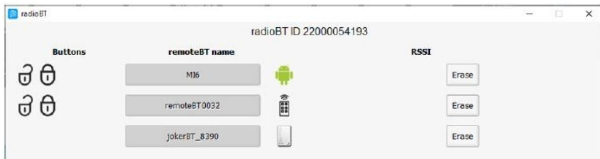
V horní části panelu je zobrazeno sériové číslo radioBT. Stisknutím sériového čísla se zobrazí další údaje pro technickou podporu Digital Systems: verze firmwaru a sériové číslo mikroprocesorů radioBT.
