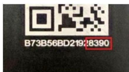
Dálkové ovládání má jedinečný název složený z předpony remoteBT a 4 číslic sériového čísla dálkového ovladače, které jsou umístěny na štítku PCB uvnitř dálkového ovladače.
