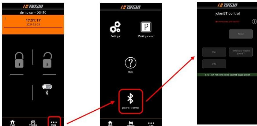
Po zapnutí se jokerBT na několik sekund pokusí připojit k telefonní aplikaci. Pro vynucený stavu zapnutí vyjměte a nainstalujte baterii do jokerBT nebo vložte a sejměte izolační fólii baterie do mezery ve spodní části pouzdra jokerBT. Izolační fólie (30mm x 5mm x 0,15mm) je dodávána s jokerBT nebo může být řezána z tuhé plastové fólie. Když je vidět ovládací panel „jokerBT“, umístěte joker co nejbližše k telefonu a přerušte napájení, jak je popsáno výše.
