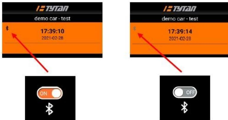
Pokud je telefon v blízkosti modulu radioBT nainstalovaného v autě a je možné připojení Bluetooth (telefon Bluetooth je povolen, hlavní spínač Tytan BT je povolen a zařízení jsou vzájemně spárována), na displeji aplikace TytanBT se zobrazí neztlumená ikona Bluetooth.
