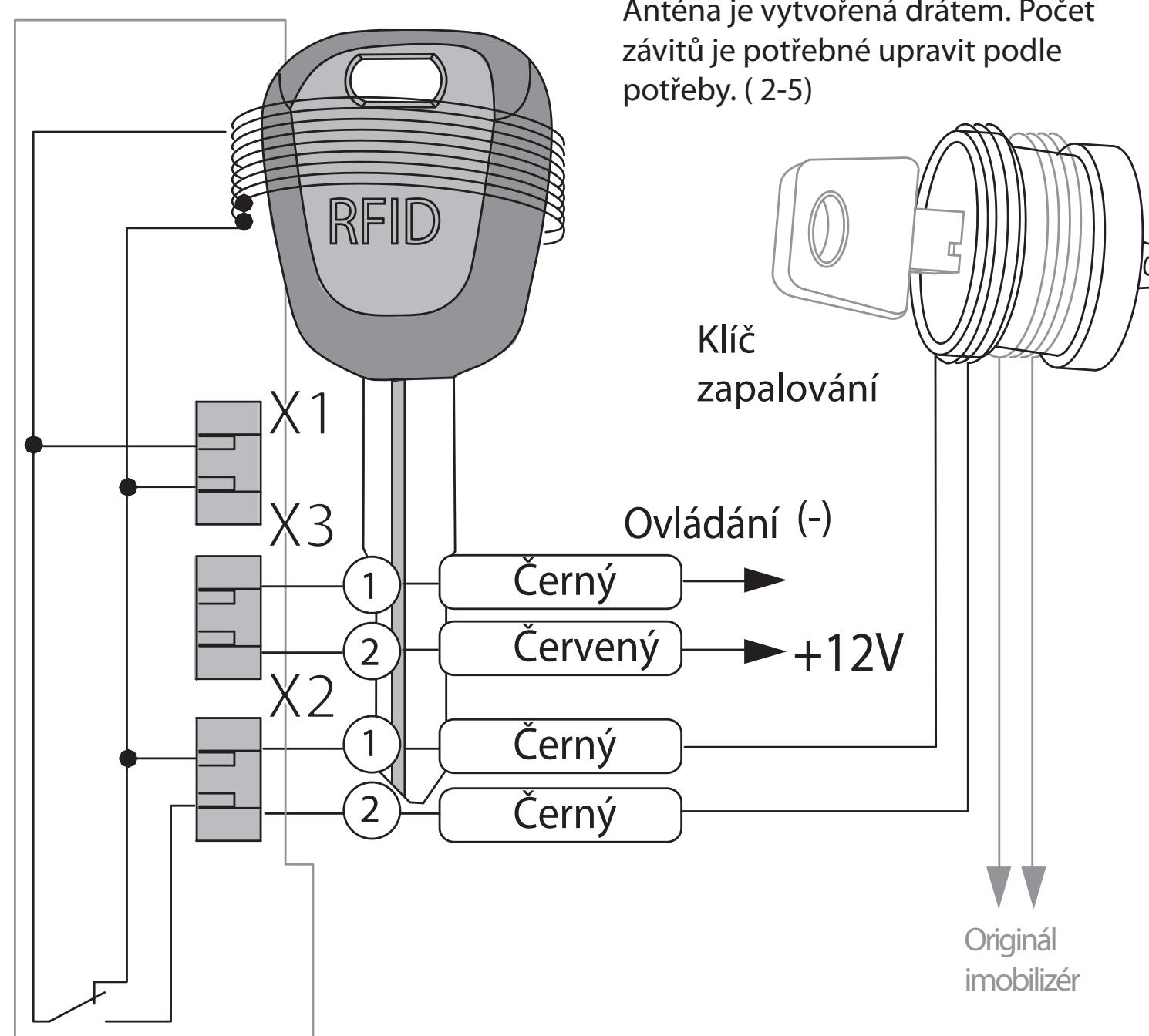
Anténa je vytvořena drátem. Počet závitů je potřebné upravit podle potřeby. ( 2-5)
