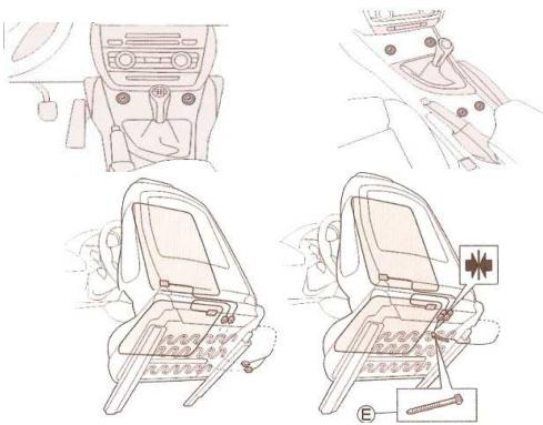
Polštářky sedací a opěrové části připevněte pomocí úchytů dle výše uvedených obrázků.
